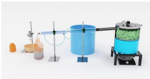
Gambar 1. Proses isolasi minyak atsiri menggunakan dandang termodifikasi
