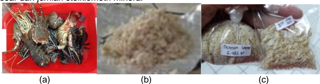
Gambar 2. Kenampakan (a) bahan baku cangkang lobster segar (b) hasil deasetilasi dan (c) kitosan lobster
