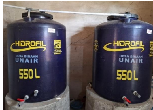
Gambar 5. Bioreaktor pupuk hayati dari Universitas Airlangga untuk Gapoktan Tani Abadi Desa Kedungpring.
